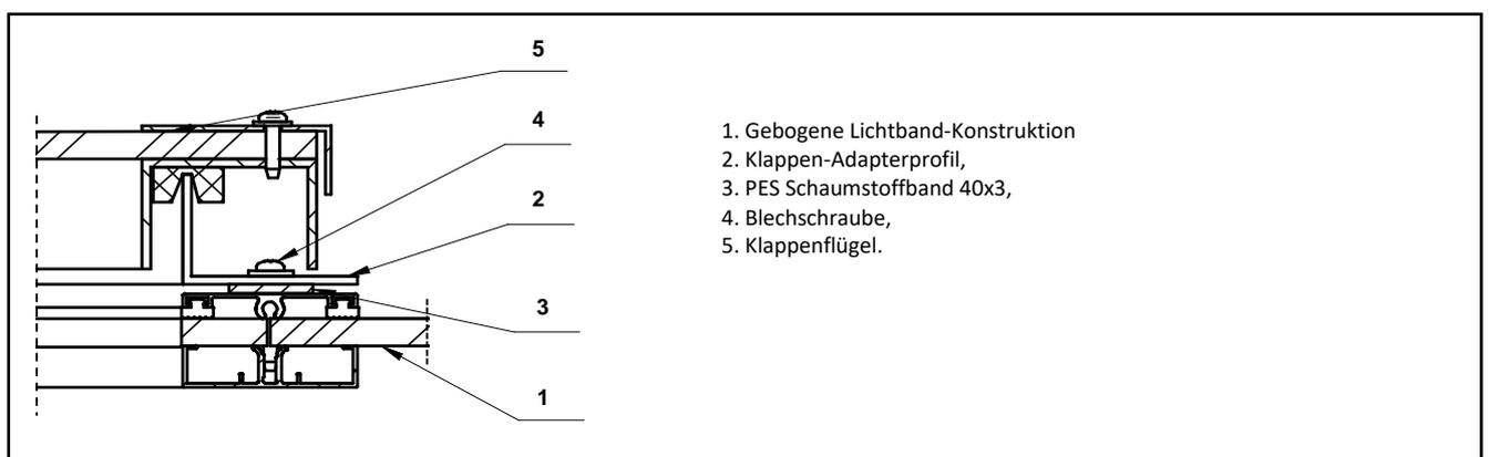
Abb. 103 Verbindung der Klappe mit der Lichtband-Konstruktion (Schnitt B-B aus der Abb. 101 Eingebaute einflügelige Lichtbandklappe (geschlossen))
